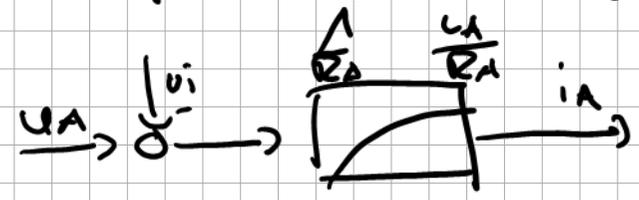
$$i_A = \frac{\frac{1}{R_A} \cdot u_A}{1 + T_A \cdot s} - \frac{\frac{1}{R_A} u_i}{1 + T_A \cdot s}$$
